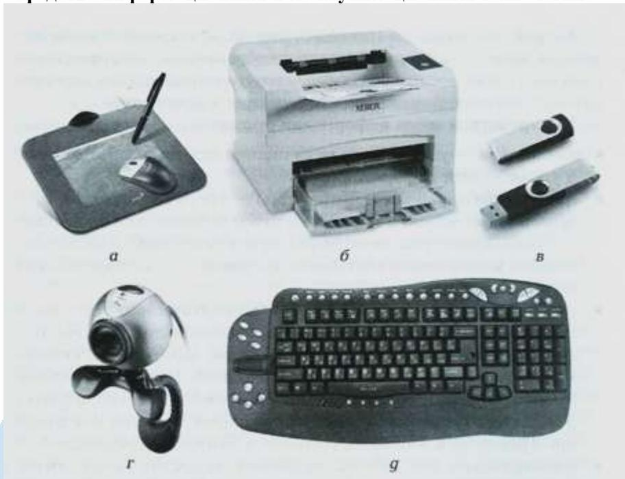
На рисунке: а – граф-планшет с пером и мышью; б – лазерный принтер; в – флеш-память; г – web-камера; д – клавиатура.
