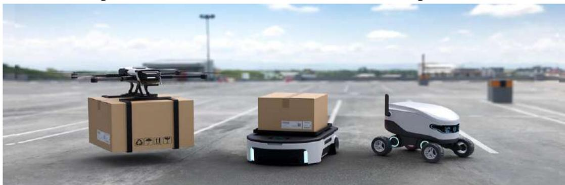
В настоящее время технологии выводят автоматизированную робототехнику за пределы производственной линии. Автономные мобильные роботы (AMR) также решают задачи, связанные с логистикой. Это автоматические машины, которые могут самостоятельно выполнять задачи, связанные со складированием и доставкой.
