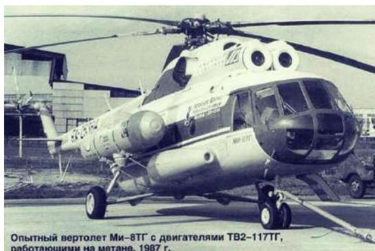
**Рис. 1 Опытный вертолет Ми-8ТГ на газовом топливе**
