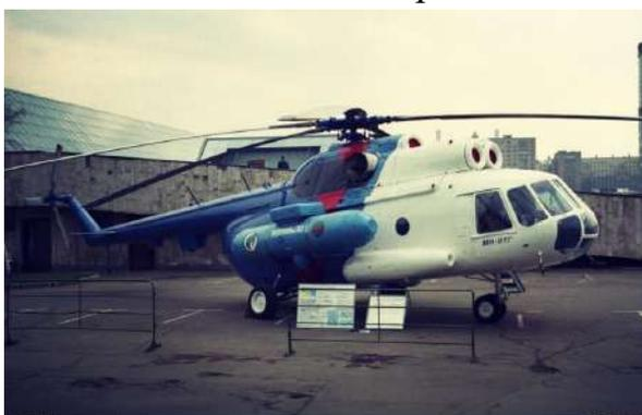
**Рис. 2 Предсерийный экземпляр вертолета Ми-8ТГ, на газовом топливе**
