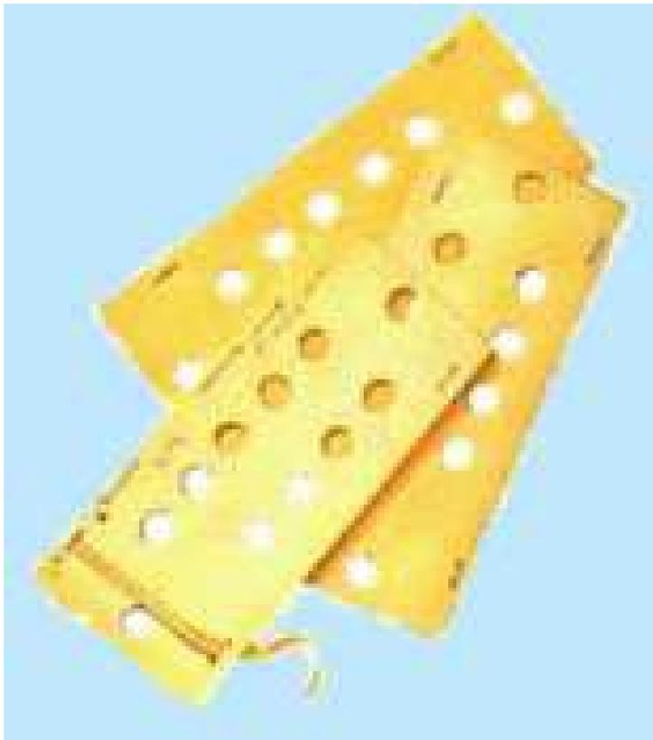
∞ **Работа станка программировалась при помощи целой колоды перфокарт, каждая из которых управляла одним ходом челнока. Переходя к новому рисунку, оператор просто заменял одну колоду перфокарт другой. Создание ткацкого станка, управляемого картами с пробитыми на них отверстиями и соединенные друг с другом в виде ленты, относится к одному из ключевых открытий, обусловивших дальнейшее развитие вычислительной техники.**
