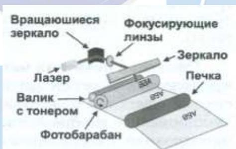
Принцип формирования изображения на лазерном принтере
